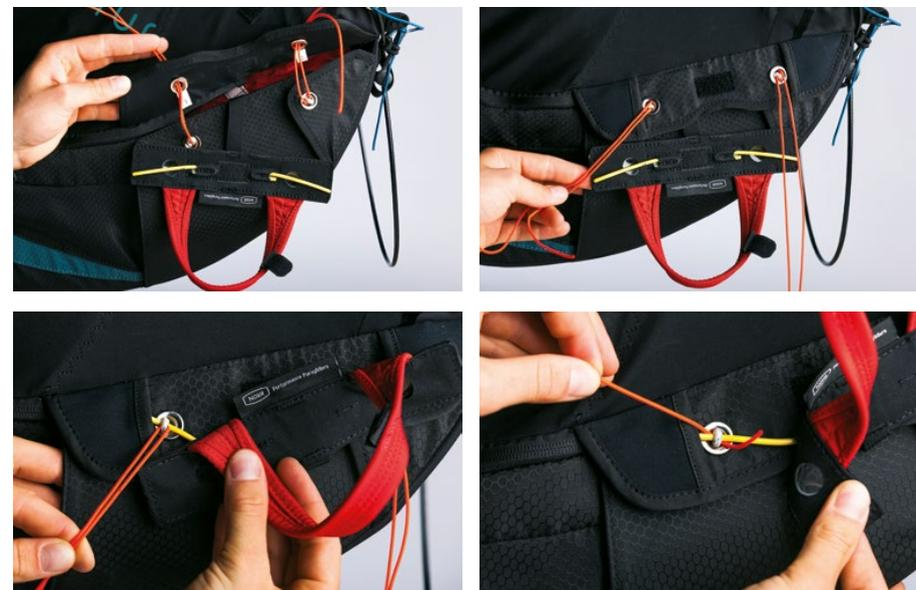
7 Une fois le container de secours fermé, l'extraction correcte du parachute doit être testée. Retirez lentement et avec précaution le morceau de suspente de parapente des boucles de fermeture et tirez sur la poignée d'extraction rouge. Si les instructions ont été scrupuleusement respectées et que tout a été parfaitement mis en place, les tiges jaunes se détachent et le parachute peut être retiré du container avec un minimum d'effort. La force requise ne doit pas dépasser sept (7) daN.
