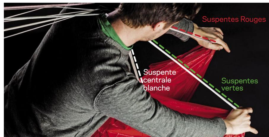
Fixer l'élévateur. Séparer les suspentes **rouge (Gauche)** and **Vertes (droite)** des blanches (centrales) et vérifiez qu'elles soient parfaitement alignées (pas d'enchevêtrement) depuis l'élévateur jusqu'à la voileure.
