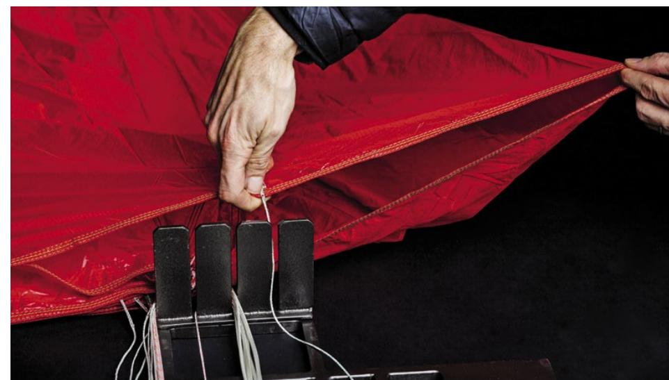
En tenant les panneaux au niveau du gousset, pliez les panneaux à couture verte un par un sur le côté droit et placez les suspentes vertes dans la fente de droite sur le peigne séparateur de suspente. Tout en séparant et en repliant les panneaux, assurez-vous que ceux-ci soient bien placés l'un sur l'autre et qu'ils forment un bord bien droit à la voile
