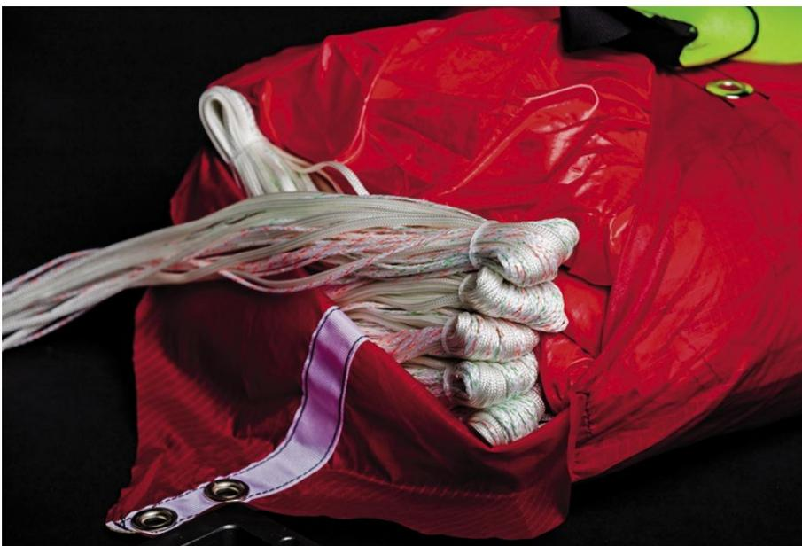
lacez les suspentes entre la voilure pliée et le côté du POD
