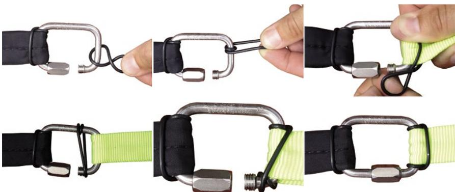
Le mousqueton / maillon doit avoir une charge minimale de rupture d'au moins 2400daN et est fixé en position avec des joints toriques ou un manchon en néoprène. **(Attention :** sous chargement transversal, le maillon perd 50% de résistance) Les sangles et brides doivent toujours reposer dans toute leur largeur sur le mousqueton à vis. Serrer avec une clé à molette.
