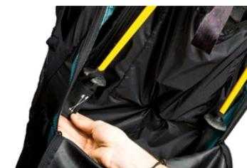
Im Staufach des ITUS sind zwei Schutzaschen für die Spitzen von Trekkingstöcken befestigt. Einfach die Stockspitze in die Schutztasche einschieben und den angenähten Sicherungsgummi über den Teller des Trekkingstocks ziehen. So ist die Stockspitze in der Schutztasche fixiert und kann nicht herausfallen. Der Pilot und das Material sind damit vor den gefährlichen Spitzen der Trekkingstöcke geschützt.
