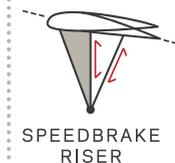
L'élévateur NOVA à retenue d'accélérateur est le premier élévateur à trois branches qui permet à la fois de rester en position accélérée et de ralentir. Plus de traction sur les C si pénalisants pour la performance.
