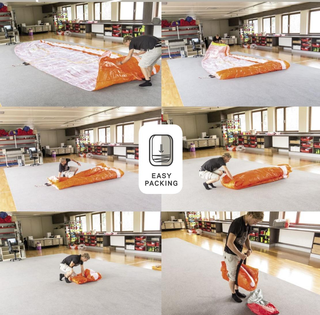
Nous conseillons de plier votre parapente de manière classique; aligner les cellules au bord d'attaque puis le reste de la voile cellule par cellule ensuite plier la voile en accordéon plutôt que de la rouler. Cela améliorera le confort au portage. Veillez à éviter de plier les joncs du bord d'attaque. Cette méthode simple de pliage est rendue possible grâce au choix des matériaux utilisés.
