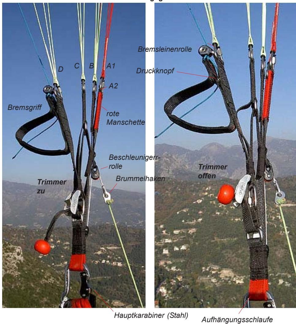
Der Trimmweg des NOVA SPEEDMAX beträgt 4 cm. Dies reicht aus, um die Grundgeschwindigkeit im Flug merkbar zu erhöhen oder durch einseitiges Öffnen das Drehmoment des Motors auszugleichen.
