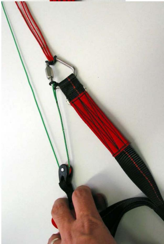
*Durch Ziehen am Griff wird die Zusatzleine gespannt, die äußere A-Leine entlastet und der Außenflügel klappt ein.*
