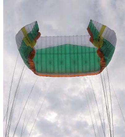
Ci-dessus, structure et grande bande de tension. Il est étonnant de voir comment des ailes apparemment si simples donnent autant d'efficacité, et aucun doute, le parapente évolue ! À droite, en allant chercher la suspente A' plus haut, on obtient de très grandes oreilles... Bien utiles quand on en a besoin...
