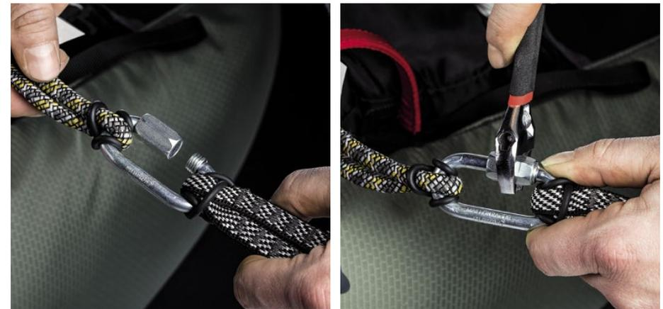
Le point de fixation sangle principale du parachute et la sellette doit être sécurisés avec des joints toriques en caoutchouc. Fermez le maillon avec une clé. Pour ce faire, suivez les instructions du fabricant de maillon.
