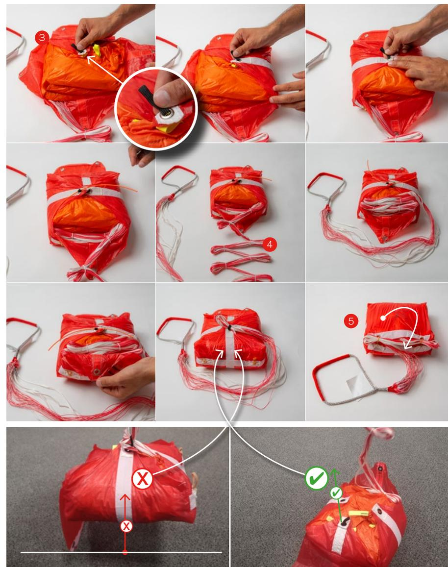
**Incorrect :** le parachute, emballé dans le POD, peut être soulevé par la sangle.
