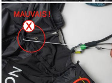
Lors de la fixation de l'accélérateur du côté droit, assurez-vous qu'il n'est pas enroulé autour de la sangle en V. Cela pourrait entraîner des problèmes en cas de déploiement du parachute. Le bon et le mauvais positionnement sont illustrés ici.
