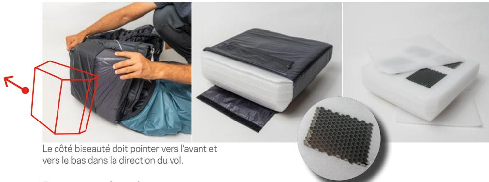
Le côté biseauté doit pointer vers l'avant et vers le bas dans la direction du vol.
